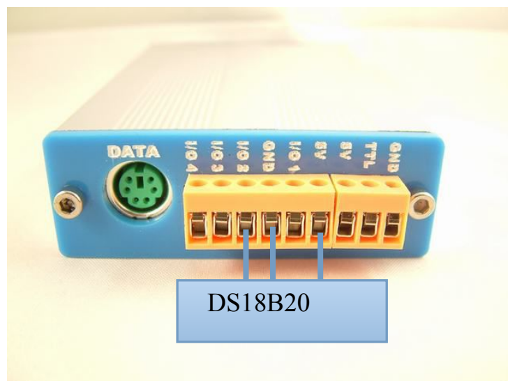
安装扩展温度传感器接线图
