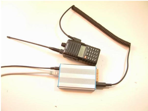
手台连接示意 (选配手台数据线)
