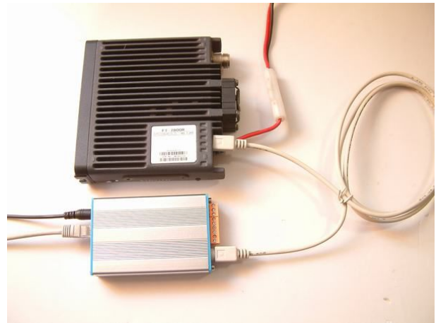
车台连接示意 (车台机制数据线标配)
